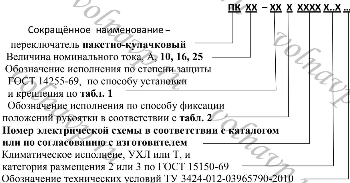
1.7 Пример записи обозначения переключателя номинального тока **16А** степени защиты **IP00** с установкой за монтажной панелью, крепление основанием, со способом фиксации **Л**, выполненного по электрической схеме **3015** при его заказе и в документации другого изделия:
